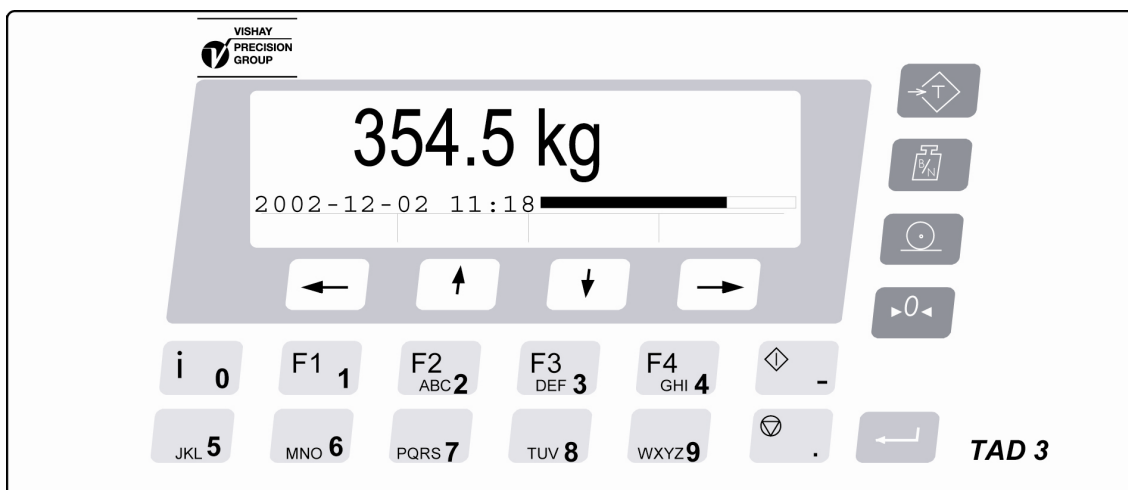
Figur 7 . Frontpanel på viktindikator TAD 3 med LCD-display, fyra funktions-tangenter nedanför displayen, fyra tangenter med vägningsymboler, tolv tangenter med bokstäver och siffror och en RETUR-tangent för att t.ex. avsluta inmatningar.
