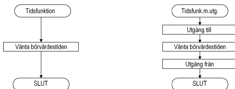
Figur 21. Flödesschemor för aktiviteterna Tidsfunktion och Tidsfunktion med utgång.
