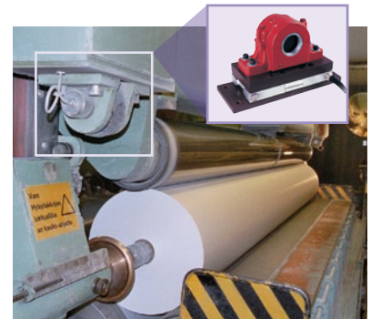
传感器安装于压纸辊上
