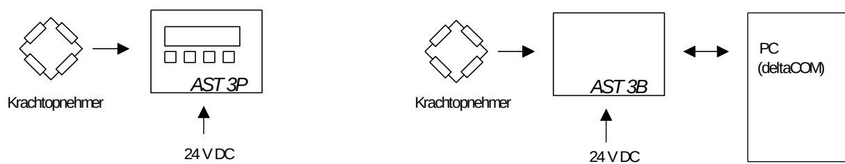
Figuur 1. De verschillende uitvoeringen vergen een verschillende installatie voor het parametren.
