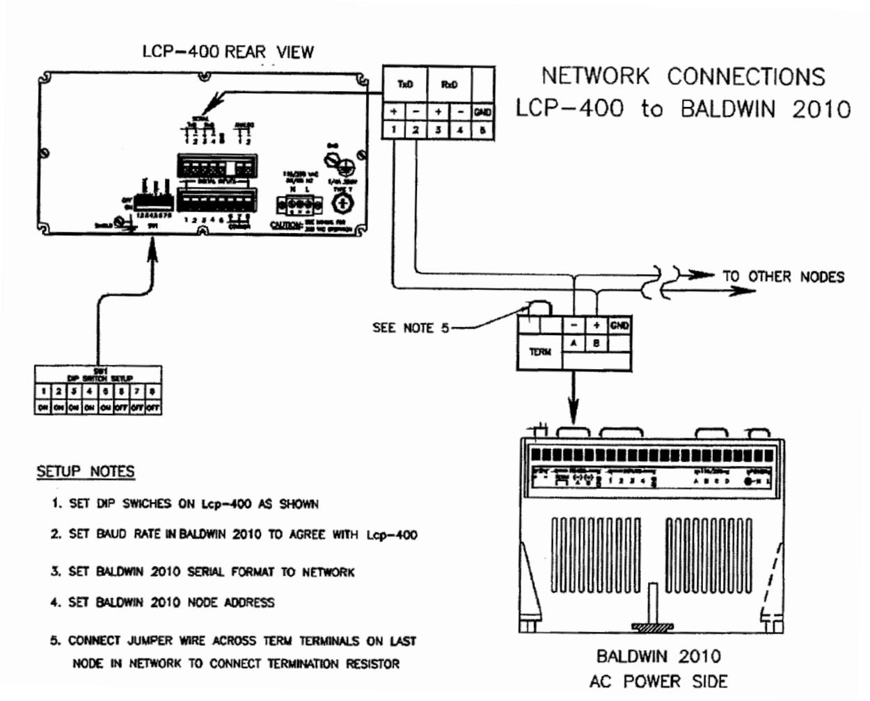
Figure 2-6. Model 2010 Digi-System Wiring Diagram.
