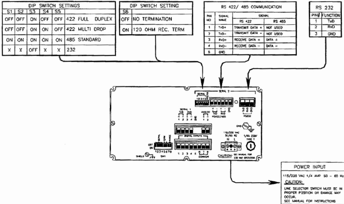
Figure 2-9. Modbus RTU Wiring Diagram.
