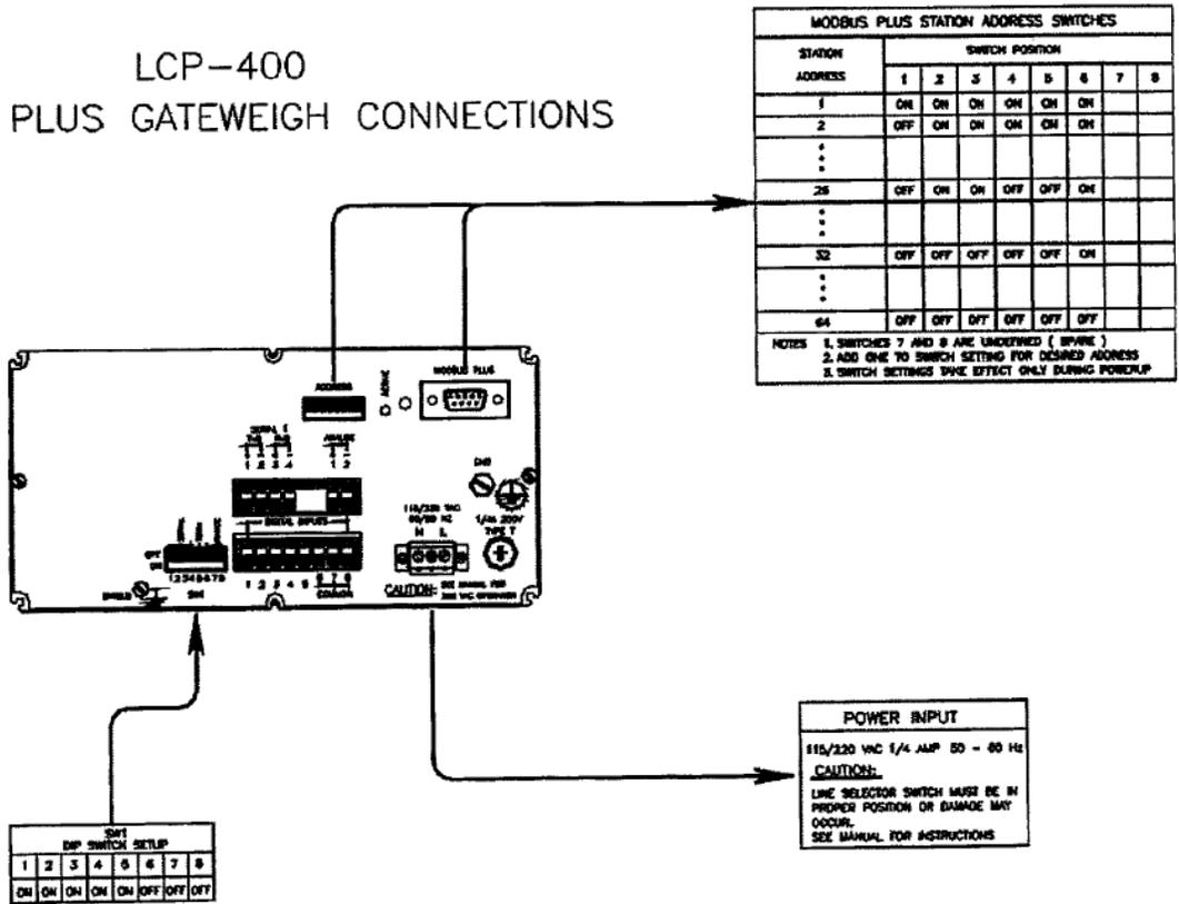
Figure 2-8. Modbus Plus Wiring Diagram.
