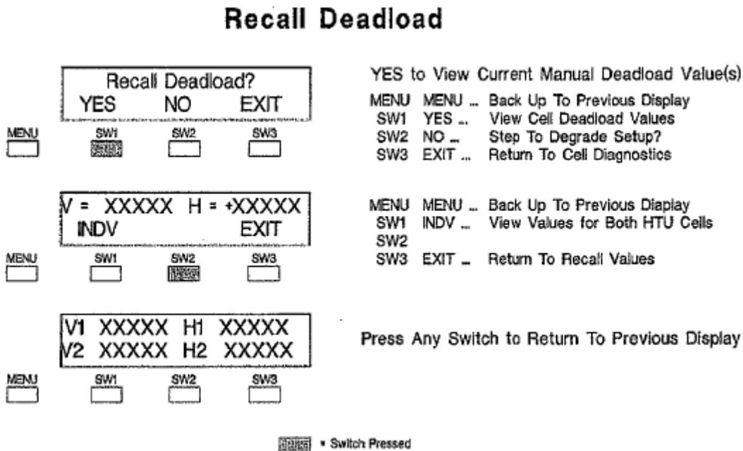
Figure 6-6. Recall Values Flow Diagram.
