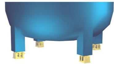
Markieren Sie das Lochmuster und bohren Sie. Montieren Sie die Bolzen und positionieren Sie die WÄGEMODULE und den Behälter neu.
