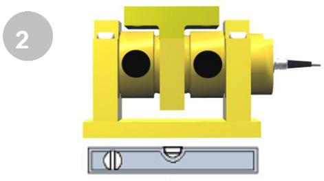
Richten Sie das WÄGEMODUL innerhalb von  $\pm 1^\circ$  in beiden Richtungen aus
