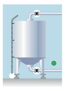
Para conseguir buenos resultados en la medida del peso, se deben utilizar conexiones amortiguadas en el depósito y verificar que ninguna escalera o otro dispositivo conecte el depósito con el suelo, paredes o techo.
